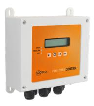
Cuadro de control y regulación automática independiente para sistemas de presurización de vestíbulos según norma EN 12101-6, compatible con los sistemas KIT BOXPDS y KIT BOXPDS SMART actuando como sensor de presión remoto, y con control automático de compuertas para mantener la sobrepresión en los vestíbulos en caso de incendio.
