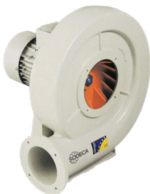
Ventilateurs centrifuges à moyenne pression, simple ouïe avec virole et turbine en fonte d'aluminium. Certificat ATEX 2G ou 2D avec moteur antidéflagrant Ex db, sécurité accrue Ex eb ou protection par virole Ex tb, pour travailler en atmosphères explosives de gaz ou de poussières.
