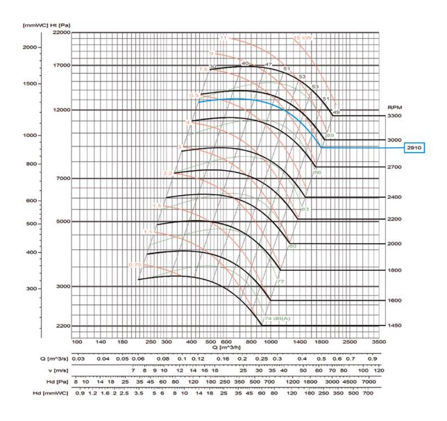
Marge de débit ±5 % Marge de niveau sonore +3... 5 dB Marge de kW absorbés ±3 %
