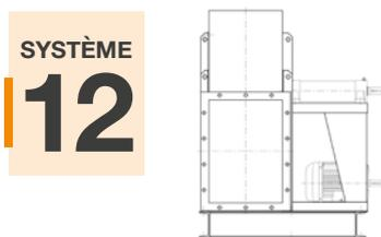
Actionnement à transmission, égal au SYSTÈME 1, moteur et ventilateur montés sur le socle commun. Positions de moteur « W » ou « Z » et, exceptionnellement, « X » ou « Y ».
