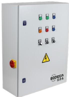
Quadro de controlo em caixa metálica com todos os elementos necessários à gestão e controlo dos ventiladores dos sistemas de ventilação dos parques de estacionamento. Os sistemas podem ser baseados em redes de condutas ou ventiladores de impulso, para controlo da concentração de CO e/ou controlo de fumos em caso de incêndio. Os quadros são feitos à medida, em função da potência instalada e número de ventiladores, de acordo com as necessidades do projeto.
